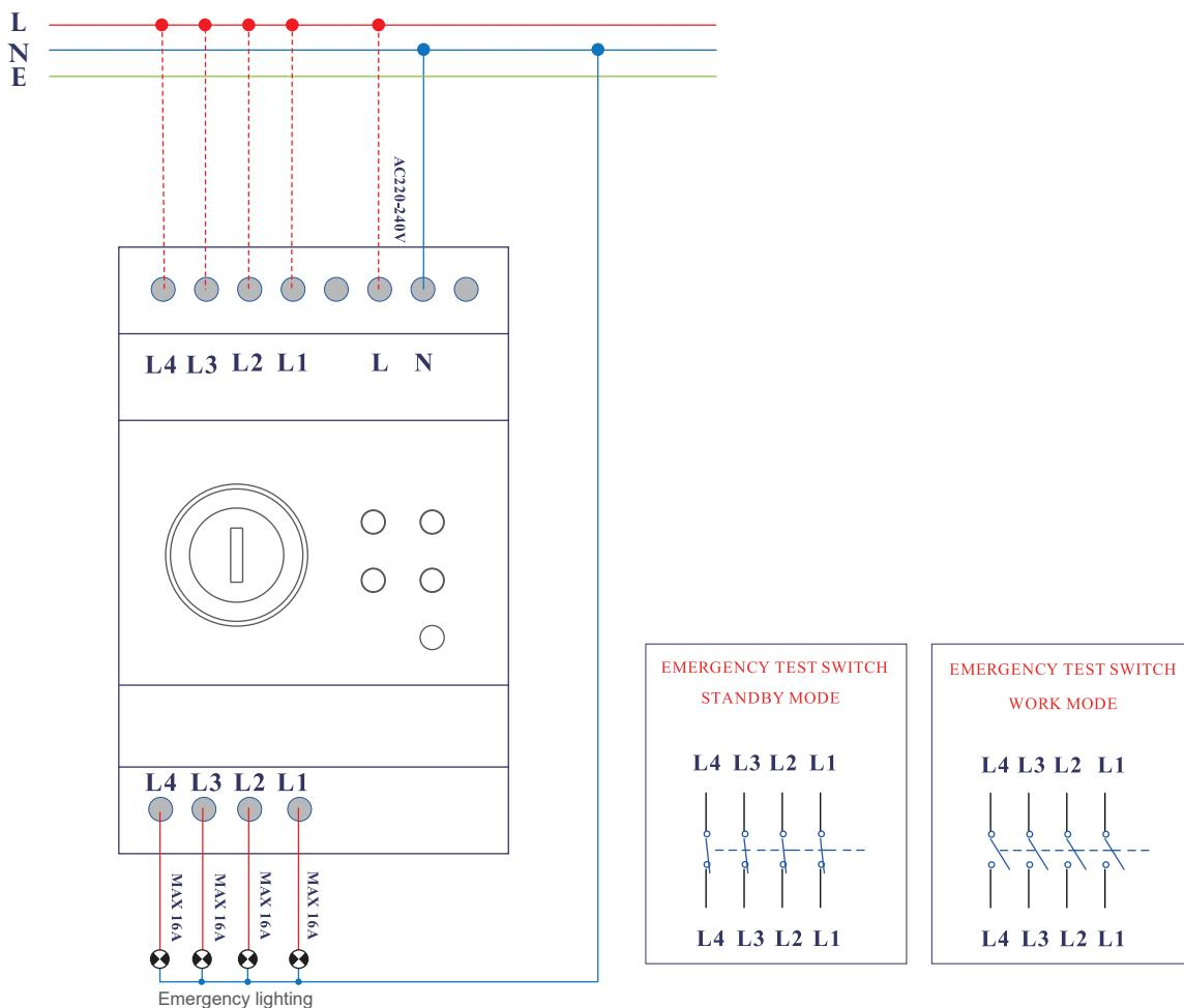
**OUTPUT CURRENT (L1, L2, L3, L4): MAX. 16A PER CIRCUIT.**
